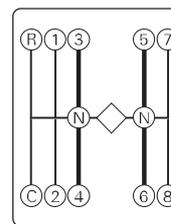
Рис. 1а, Схема переключения передач каскадное Н
