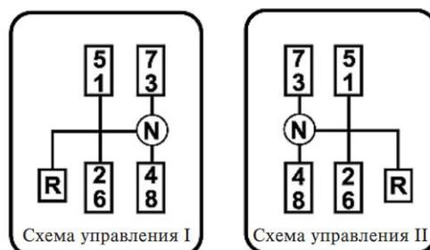
Рис. 2а Схема переключения "налагающаяся Н"
